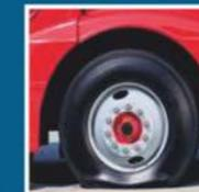
A maioria dos danos nos pneus é devida a pressões incorretas. Por isso, os pneus de camiões e autocarros devem ser insuflados em função da carga que transportam. Manter uma pressão de ar correta é tão essencial para a condução como abastecer o camião de combustível. Não é o pneu que suporta a carga, mas o ar pressurizado no seu interior que a suporta.
