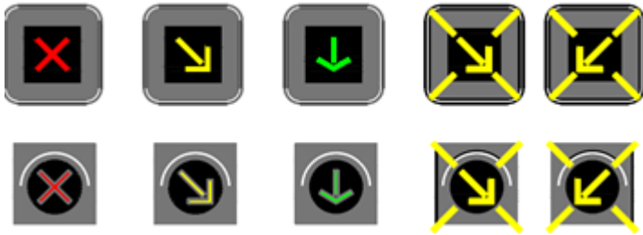
S12, S13, S14 e S15 – Sinais luminosos de afetação de vias
